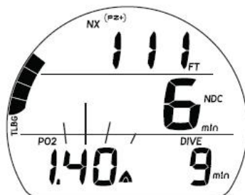
Fig. 73 - PO2 ALARM MAIN
