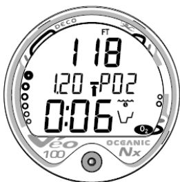
Fig. 47 - HIGH PO2 WARNING
