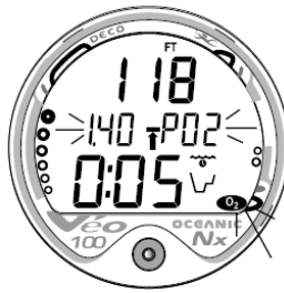
Fig. 48 - HIGH PO2 ALARM
