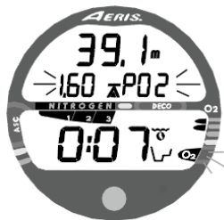
Fig. 48 - HIGH PO2 ALARM
