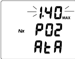
Fig. 30 - SET PO2 ALARM
