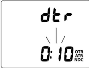
Fig. 27 - SET DTR ALARM sado
